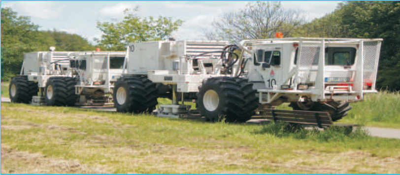
Exploration: Spezialfahrzeuge (Vibratoren) senden Wellen in den Untergrund,...
