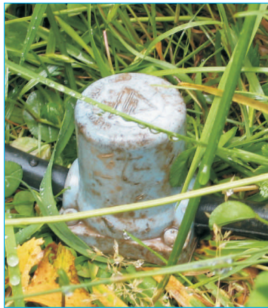
...die von vielen kleinen Seismographen („Geophone“) empfangen werden...
