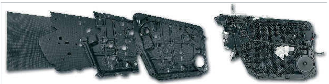
Bezahlbarer Leichtbau für die Großserie: Die erhitzte Matte aus glasgewebeverstärktem Polypropylen (Organoblech) wird in der Spritzgussmaschine in Form gepresst. Zeitgleich werden die Funktionselemente aus glasfaserverstärktem Polypropylen angespritzt ■
