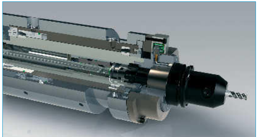
Mit der Plananlagenkontrolle kann der Maschinenanwender jede Verschmutzung zwischen Werkzeug und Spindelnase die größer ist als 0,01mm sicher messen. Die Qualität der Produktion wird dadurch sicher gestellt ■
