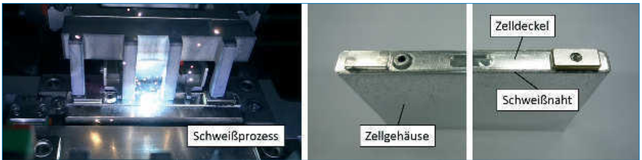
Abb. 5: Laserschweißen des Zellgehäuses, links: Schweißprozess, Mitte: Vormontierte Zelle, rechts: Verschweißte Zelle ■
