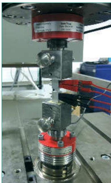
Abb. 2: Versuchsaufbau mit idealisierten Aluminiumkontakten unter zyklisch pulsierender Druckbelastung ■
