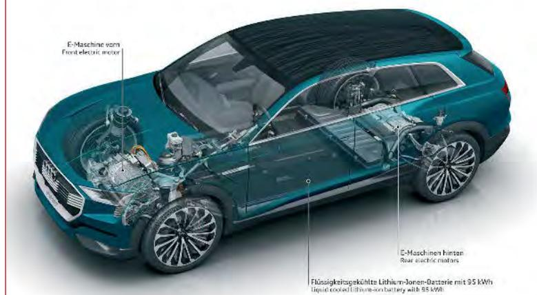
Audi e-tron quattro concept - elektrischer Antriebsstrang mit bis zu 370 kW Leistung ■
