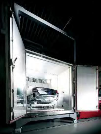
grammiert werden. Die beiden Wärmeöfen bis zu einem Volumen von 720 Liter ermöglichen Tests bis  $300\text{ }^{\circ}\text{C}$ . Die Salzsprühnebelkammer mit einem Prüfvolumen von  $2\text{ m}^3$  erfüllt alle gängigen Prüfnor-
