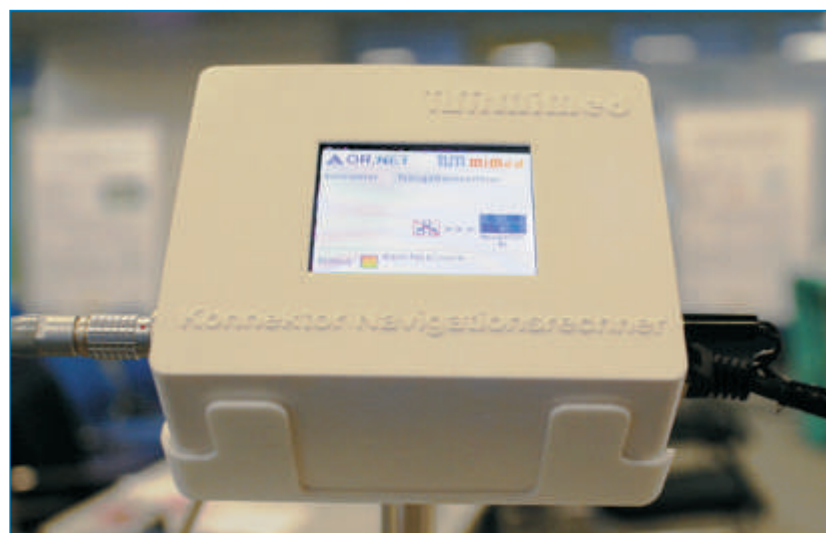
Abb. 2: Der Konnektor für den Navigationsrechner. Auf dem Display werden Statusinformationen über das Netzwerk angezeigt ■
