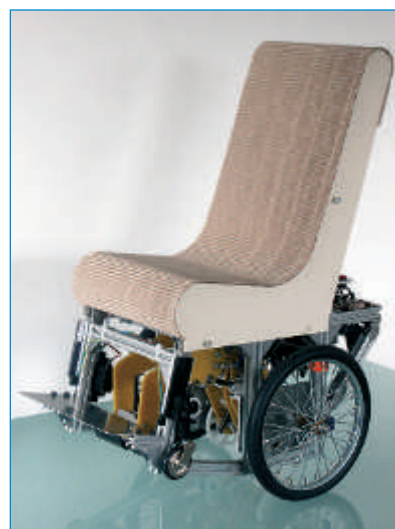
Abb. 5: Modell des Systems „AssistMobil“. In der Ebene balanciert der bionische Rollstuhl auf zwei Rädern, die zusätzlichen Beine zum Treppensteigen sind gelb und im Fahrwerk eingeklappt ■
