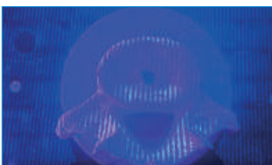
Ein strukturiertes Muster wird auf das Objekt projiziert, die Oberfläche von einer Kamera erfasst ■
