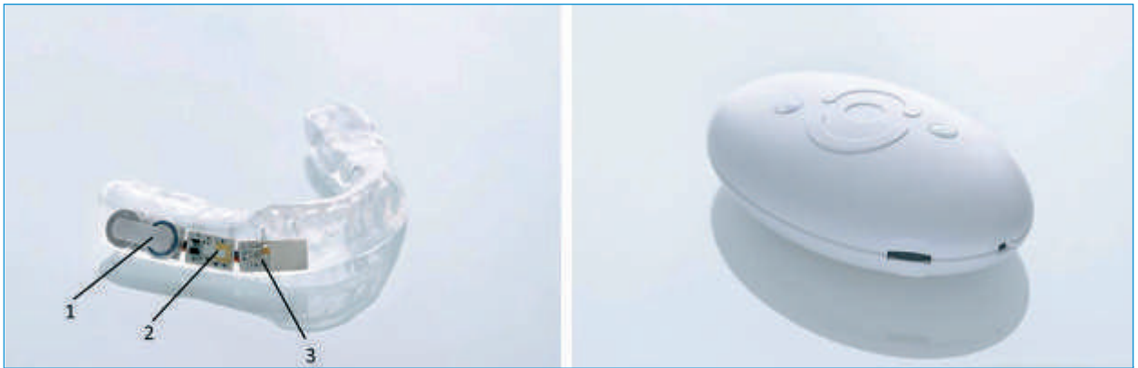
Abb. 4: Links: Intelligente Zahnschiene mit Batterie (1), Sensorik (2) und Antenne (3). Rechts: Empfänger für den Erhalt der Daten und das Aussenden von Biofeedback (Vibration bzw. Geräusche) ■
