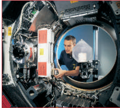
Siemens AG, Röntgenstrahler für die Computer-Tomographie und für die Angiographie. Jeder Strahler wird in einem Siemens-Computertomographen geprüft, bevor er das Technologiezentrum verlässt ■
