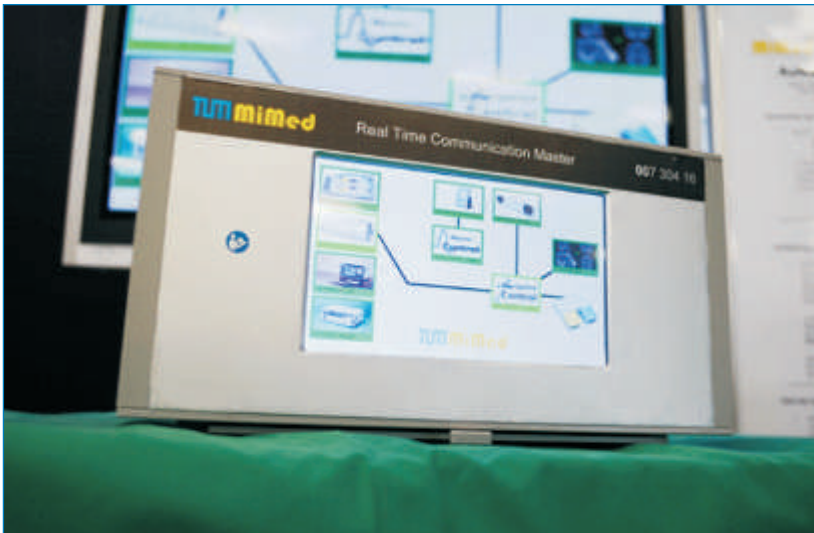
Abb. 3: Zentraler Master des am MiMed entwickelten, echtzeitfähig vernetzten Operationssaals ■
