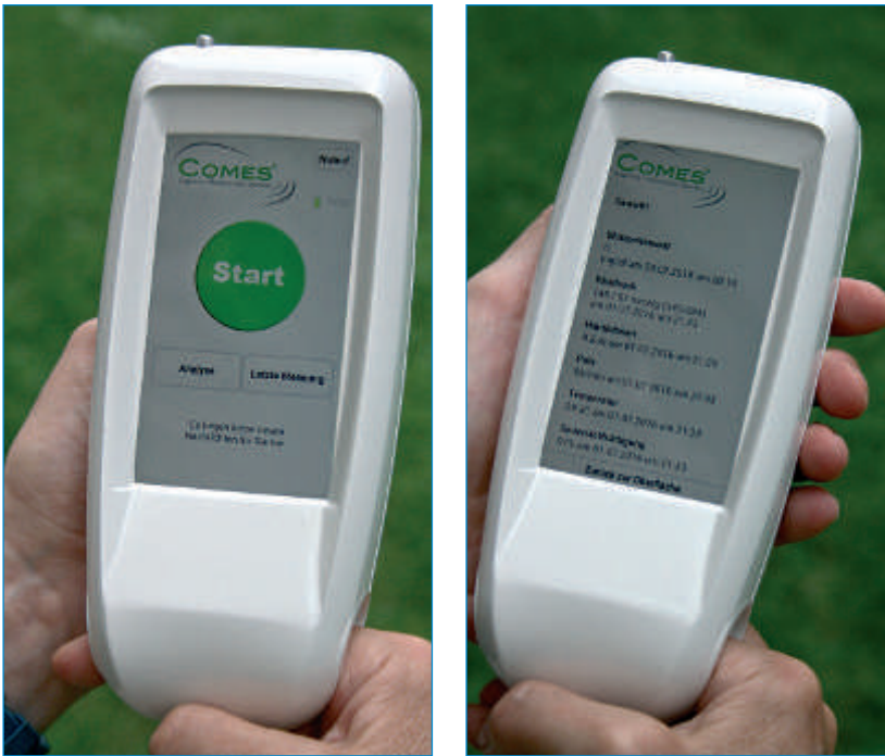
Abb. 2: All-in-One-Medizingerät. Links: Zum Ermitteln verschiedener Vitaldaten wird der Finger in die Messmanschette im unteren Bereich des Geräts eingelegt und der Start-Button gedrückt. Rechts: Nach kurzer Zeit erscheinen die Daten auf dem Display und werden auf Wunsch per Mobilfunk an die Telemedizin-Plattform COMES® übermittelt ■
