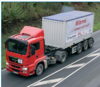
Mobiler Latentwärmespeicher von Fraunhofer UMSICHT. Foto: Fraunhofer UMSICHT ■
