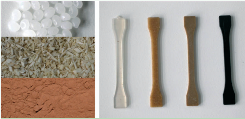
Links von oben nach unten: Polymilchsäuregranulat (PLA), Holzfasern, Ligninpulver, rechts Biokunststoffprüfkörper: (von links): PLA, 2xPLA+Holzfasern, PLA+Ligninpulver ©Fachgebiet Biogene Polymere, TUM ■
