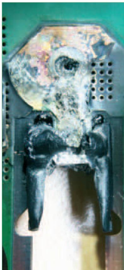
Durch Reibkorrosion geschädigte Leiterplatte eines Solar-Moduls Foto: Fraunhofer IZM ■
