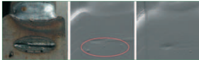
Abb. 2: Tomosynthese-Rekonstruktion der Oberfläche einer Schweißverbindung und der im angeschweißten Stahlprofil verborgenen Strukturen. Die Durchschweißung wird anhand des Grauwertverlaufs in beiden Schichten klar sichtbar. Die erzielte Auflösung an dem flächenhaft ausgeprägten Bauteil beträgt ca. 25 µm ■
