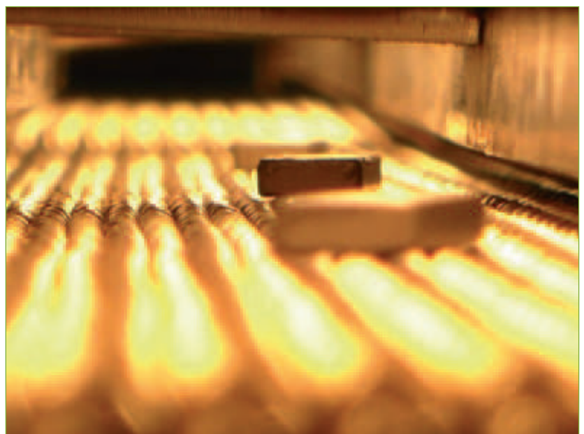
Abb. 2: Ofenstrecke zur thermischen Entmagnetisierung von Hochleistungsmagneten ■
