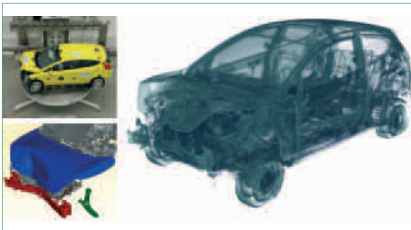
Abb. 4: CT-Scan eines Crashfahrzeugs, 3D-Rendering (rechts) und Extraktion deformierter Bereiche (links unten) ■
