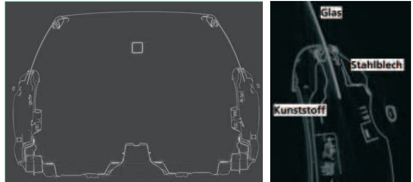
Abb. 5: CT-Schnittbild durch die Fahrgastzelle (links) und vergrößerte Abbildung des Türbereichs (rechts) ■
