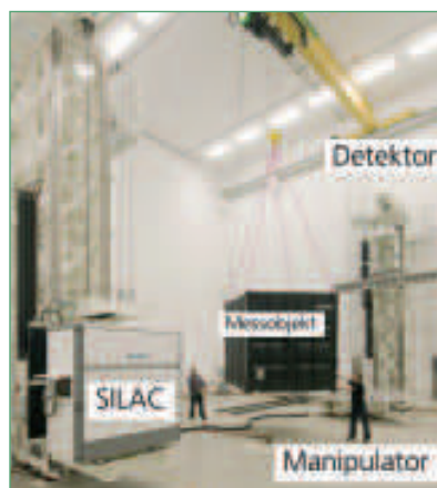
Abb. 3: Aufnahme der Inneneinrichtung der Hochenergie-Testhalle. Strahlungsquelle und Detektor sind über ein Turmsystem in der Höhe verfahrbar, um große Objekte komplett abzutasten und Projektionsbilder von bis zu 5m x 4m (Höhe x Breite) mit einer Abtastung von 400 µm zu generieren ■
