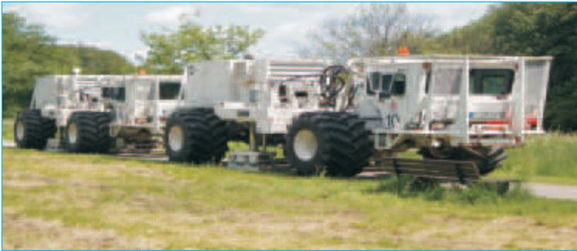
Exploration: Spezialfahrzeuge (Vibratoren) senden Wellen in den Untergrund,...
