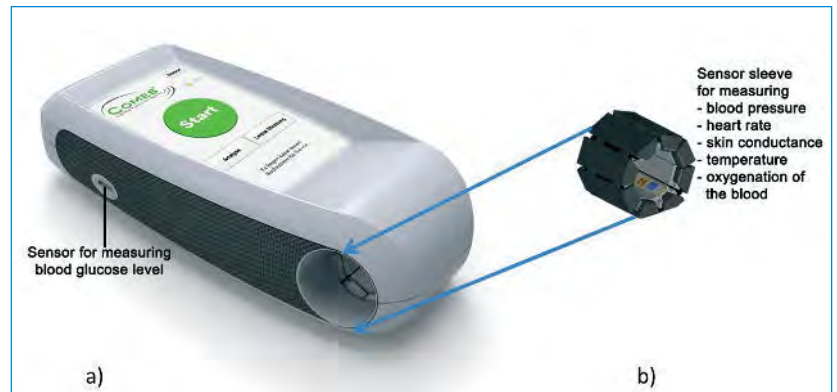
Fig. 6: a) All-in-one telemedical device as developed by Heinz Nixdorf-Lehrstuhl für Medizinische Elektronik, Technische Universität München, in collaboration with the Fachgruppe Produktentstehung, Heinz Nixdorf Institut, Universität Paderborn. Design: Abteilung für Industrial Design, Kunstuniversität Linz, Prof. Axel Thallemer; b) Sensor sleeve, detailed view ■
