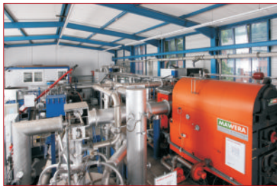
Feuerungstechnikum des Institutsteils Sulzbach-Rosenberg des Fraunhofer-Instituts für Umwelt-, Sicherheits- und Energietechnik UMSICHT zur Untersuchung des Verbrennungs- und Emissionsverhaltens verschiedener Biomassebrennstoffe ( http://www.umsicht-suro.fraunhofer.de ) ■
