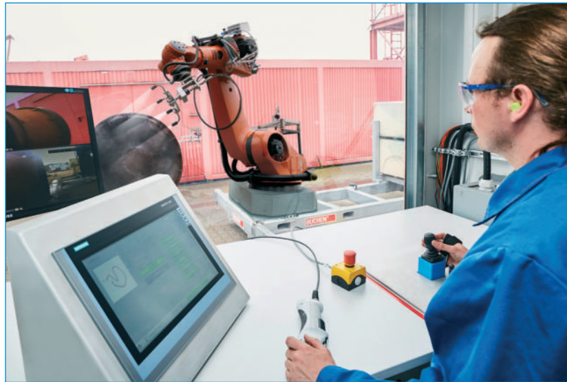
Der von BUCHEN entwickelte Automated Industrial Cleaner wird per Joystick gelenkt, wobei sich der steuernde Mitarbeiter fern der eigentlichen Gefahrenzone in einem Bediencontainer aufhält ■
