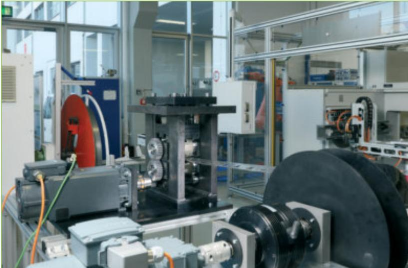
Abb. 3: Prototypische Anlage zum Rotationsschneiden von Elektrobänd als ergänzende Alternative zum konventionellen Stanzen ■
