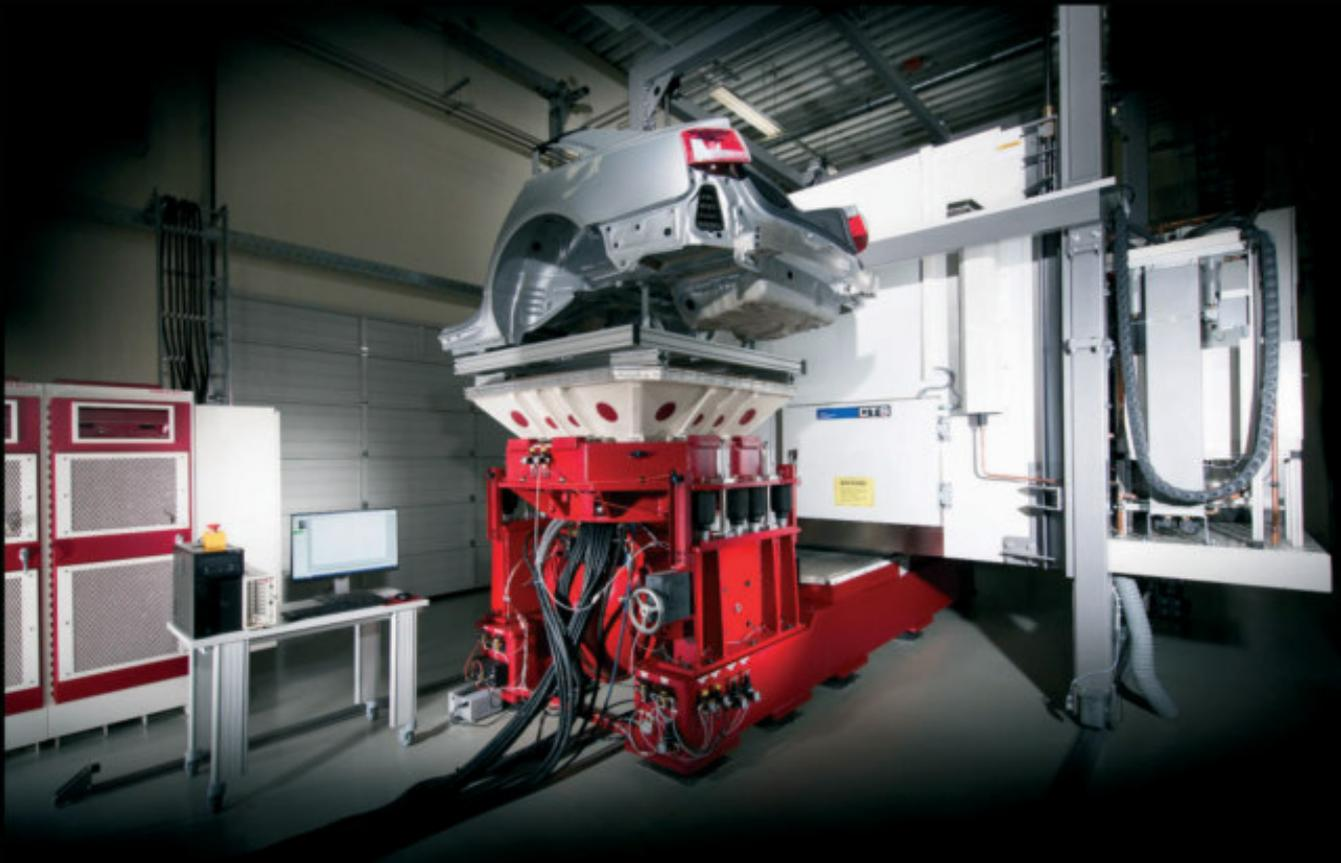
ist befahrbar. Die Temperaturbereiche liegen zwischen  $-70\text{ }^{\circ}\text{C}$  und  $180\text{ }^{\circ}\text{C}$ , die relative Luftfeuchtigkeit kann zwischen 10 % und 97 % stufenlos pro-
