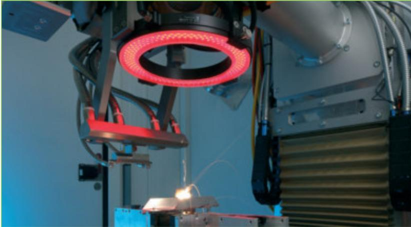
Abb. 5: Versuchszelle zum Laserschweißen für die Erforschung laserbasierter Prozesse zum Fügen von Kupferwerkstoffen ■
