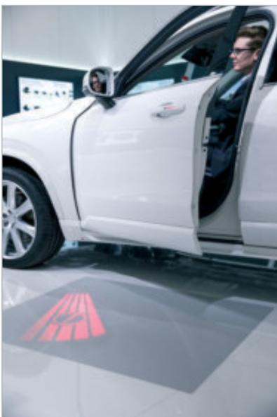
Der elektrische Seitentürantrieb von Brose soll den Zugang zum Fahrzeug so komfortabel wie nie zuvor gestalten. Öffnet sich die Tür selbsttätig, ist ein zuverlässiger Kollisionsschutz unabdingbar. ■
