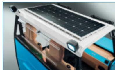
Auf dem Dach des Fahrzeugs sind Solarmodule angebracht.
