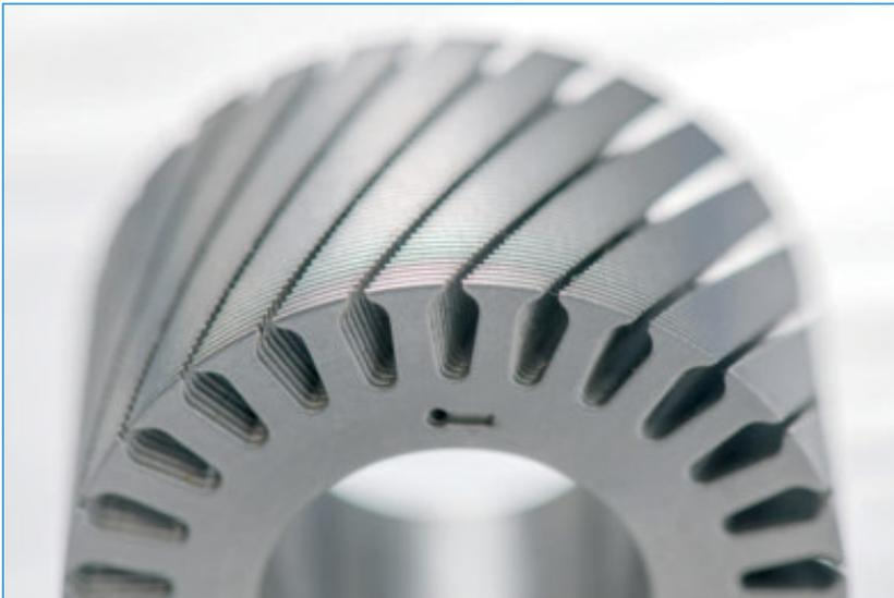
Einzelne Elektroleche werden zu einem kompakten Paket zusammengefügt. Das Bild zeigt ein Rotorblechpaket. (Foto: Andreas Heddergott / TUM) ■
