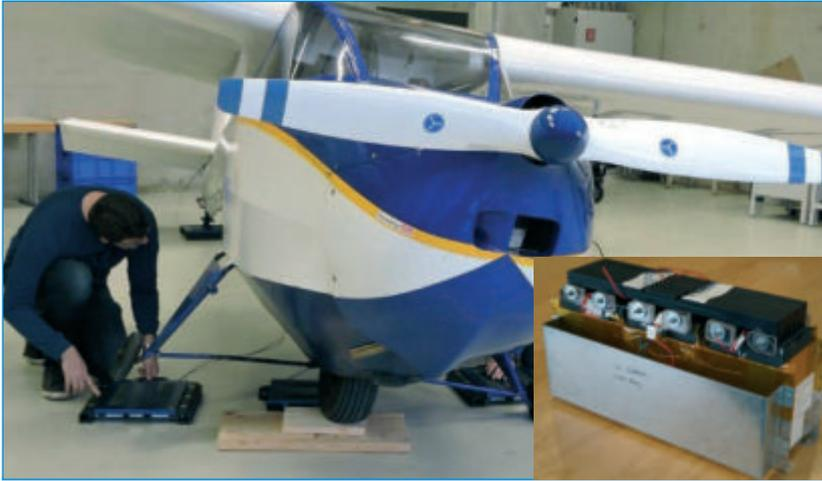
Abb. 2: Batteriemodul des E-Falke Projekts der Technischen Hochschule Ingolstadt ■
