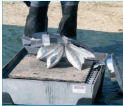
Abb. 3: Batteriepack nach Überladeversuch ■
