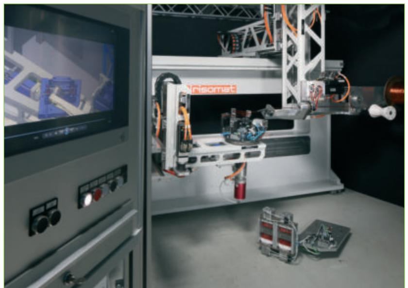
Abb. 4: Innovative Universalwickelmaschine zur flexiblen Herstellung verschiedener Wickelschemata mit variierenden Drahtgeometrien ■
