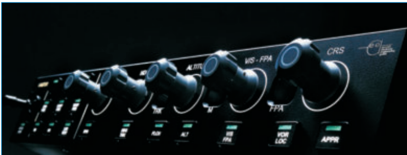
Mode Control Panel – ermöglicht es der Crew auszuwählen, welche Teile des Flugs automatisch gesteuert werden ■
