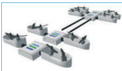
3D Zeichnung des modularen Syrphus Auftriebskonzepts ■
