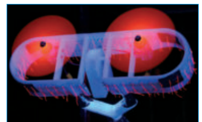
Syrphus Airframe während Windkanalversuchen ■
