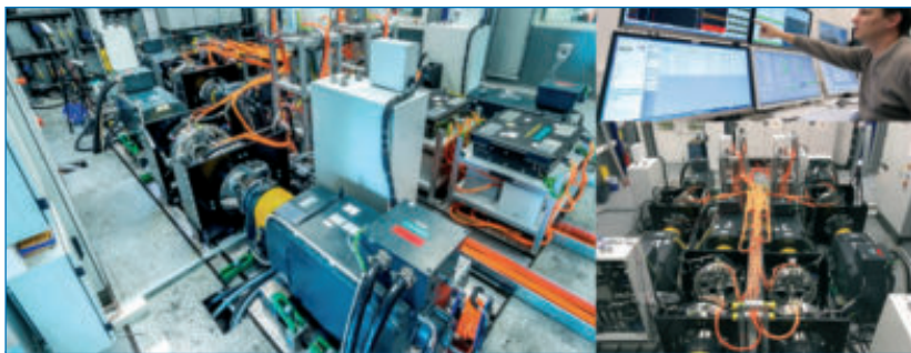
Das Airbus E-Aircraft Systems Testlabor in Taufkirchen zur Systemintegrationsprüfung des in Zusammenarbeit mit der Siemens AG entwickelten elektrischen Antriebssystems für den CityAirbus. Die Erprobung des Gesamtsystems zielt darauf ab, die Funktionalität und Leistung des elektrischen Antriebssystems unter Berücksichtigung seiner Wechselwirkungen zwischen elektrischen und mechanischen dynamischen Subsystemen im Missionsumfeld zu überprüfen. Das getestete elektrische Antriebssystem besteht aus dem elektrischen Netzteil (8x120kW-Motoren), 800VDC-Stromverteilern, (4x30kWh) Li-Ion-Batteriepaketen und dem Flugsteuerungssystem für Flugzeuge. ■
