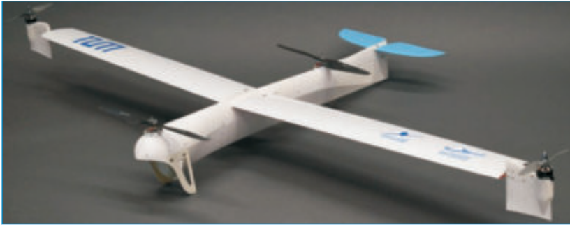
Transitions-UAV: Hohe Effizienz im Streckenflug bei senkrechter Start- und Landefähigkeit ■
