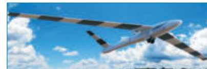
Unbemannter Versuchsträger für hochflexible Flügelkonzepte (EU Projekt FLEXOP) ■
