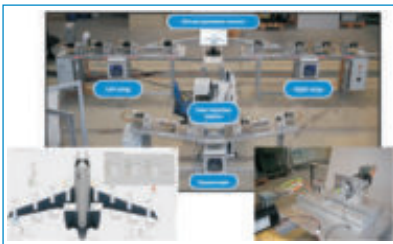
UAV Iron Bird – Systemtests auf Komponenten- und Gesamtsystemebene ■
