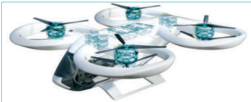
Flugtaxis CityAirbus: der Demonstrator von Airbus, 4-sitzigem eVTOL wird mit Siemens gemeinsam entwickelt und durch acht verteilte Motoren angetrieben ■
