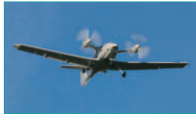
DA40 mit seriellem hybrid-elektrischem Antrieb nach dem Jungfernflug im November 2018: Das Gemeinschaftsprojekt von Diamond Aircraft und Siemens eAircraft beweist die technische Machbarkeit einer dezentralen Antriebsarchitektur ■
