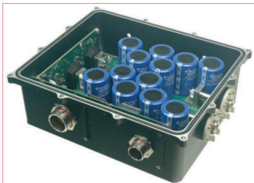
DMCU, ein kompaktes high-performance Steuergerät für Duplex-Motoren in elektrischen Niederspannungs-Antriebssystemen. © Silver Atena
