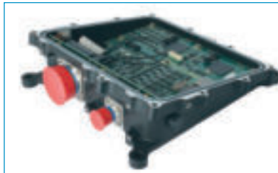
Auf dieser leistungsfähigen Rechnerplattform für die hochautomatisierte Steuerung von bemannten oder unbemannten Kleinflugzeugen und Hubschraubern lässt sich beispielsweise ein Flight Control Computer realisieren. © Silver Atena ■
