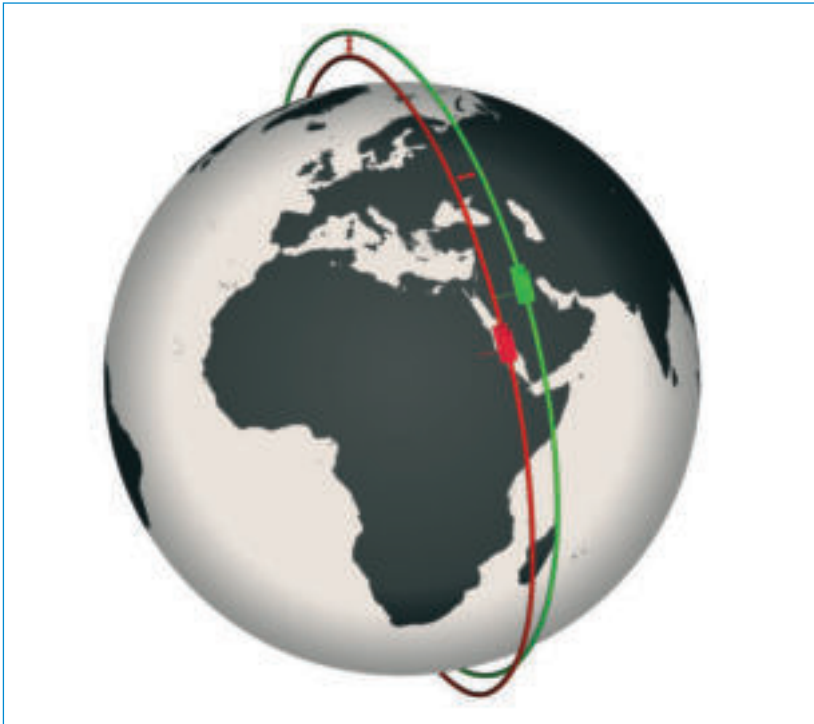
Illustration der Helix-Formation: TerraSAR-X bewegt sich in der rot markierten Umlaufbahn, TanDEM-X in der grün markierten; typische Basislinien variieren zwischen 120 und 500 m; die Bahnen kreuzen sich nicht. ■
