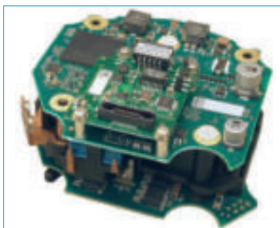
Beispiel eines bauraumoptimierten 5-kW-Antriebsreglers, © Silver Atena ■
