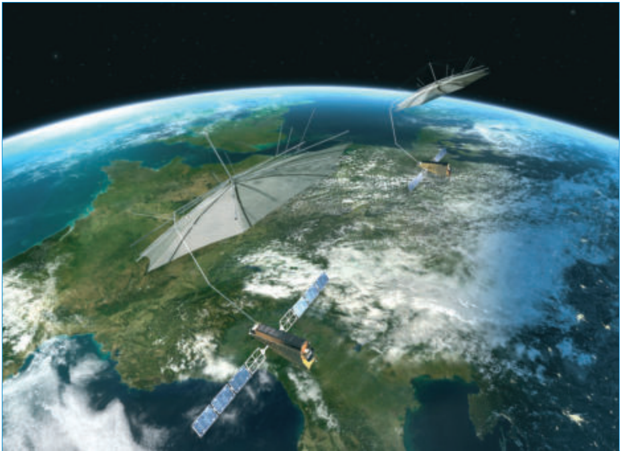
Tandem-L-Satelliten im Formationsflug mit einem großen entfaltbaren Reflektor mit 15 Metern Durchmesser. ■
