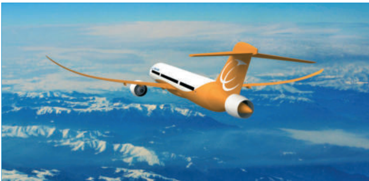
EU-Projekt „CENTRELINE“ – Synergistische Integration eines hybridelektrischen Antriebes im Flugzeugheck ■
