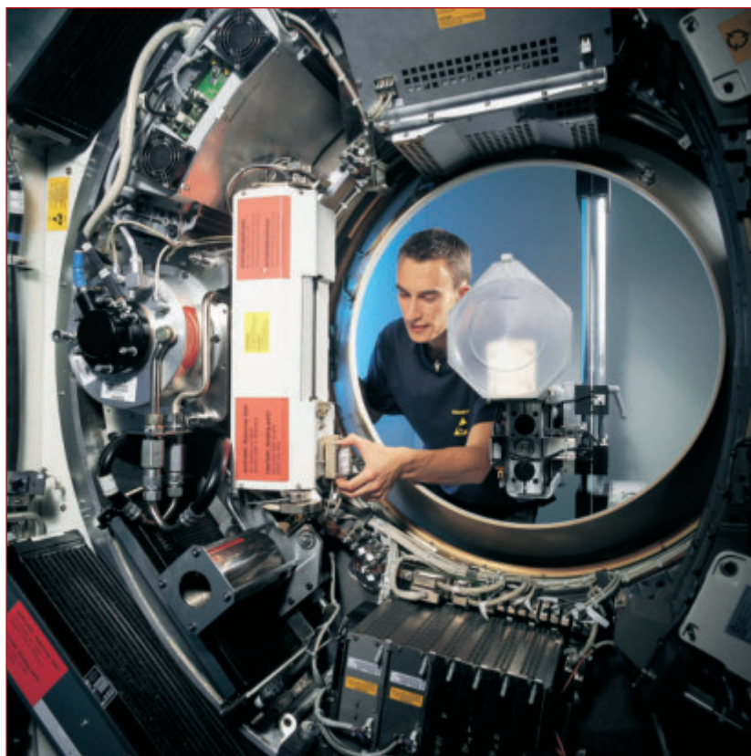
Siemens AG, Röntgenstrahler für die Computer Tomographie und für die Angiographie. Jeder Strahler wird in einem Siemens-Computertomographen geprüft, bevor er das Technologiezentrum verlässt. Bildquelle: Kurt Fuchs, Fuchs Foto-Design, Erlangen ■
