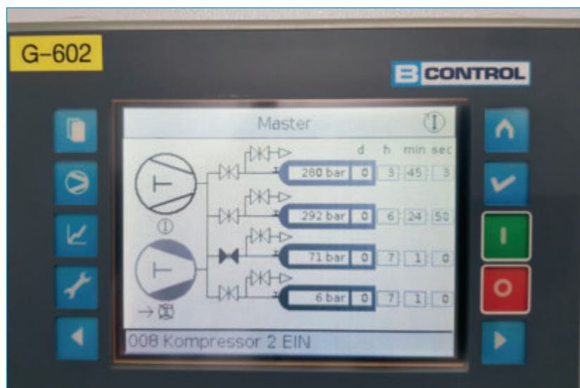
Das Display der B-CONTROL Steuerung informiert zuverlässig in Echtzeit über alle Parameter des Füll- und Entleerungsprozesses. ■
