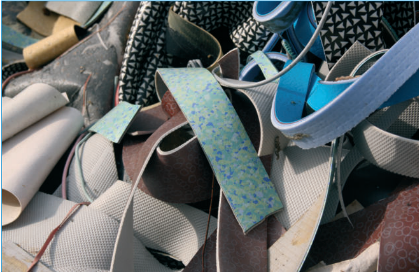
Ausgesonderte PVC-Böden werden geschreddert und so für das CreaSolv® Recycling vorbereitet. Copyright: Arbeitsgemeinschaft PVC Bodenbelag Recycling ■
