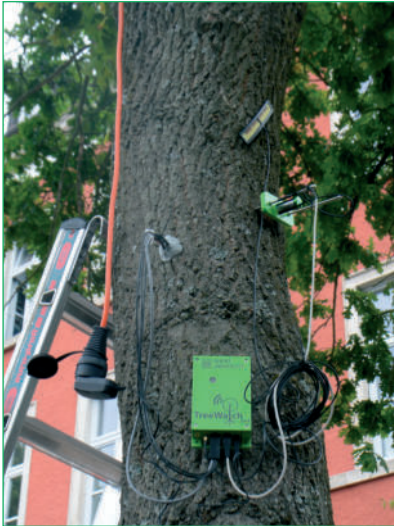
Abb. 2: Aufbau eines internetfähigen „Talking Trees“, am Gymnasium Wunsiedel. Sichtbar sind (von links nach rechts) Messfühler zur Messung des Wassertransportes (grau), eine Datenlogger mit Übertragungseinheit (grün), sowie eine Dendrometer zur Messung des Baumwachstums (grün, am Stamm rechts oben) sowie die Sendeantenne (oben). ■
