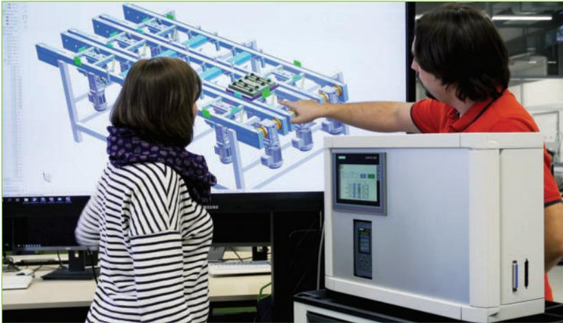
Abb. 4: Hardware in the Loop (HiL) stellt einen Modus der virtuellen Inbetriebnahme dar, bei dem die tatsächliche Steuerung mit einem virtuellen Anlagenmodell interagiert. ■
