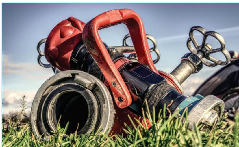
Abb. 4: Feuerwehr Schlauchverteiler mit Ventilabsperung
