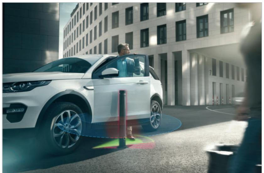
Brose Seitentürantrieb mit Radar-Kollisionsschutz ■
