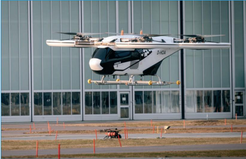
Powered by Rolls-Royce: für den CityAirbus entwickelte das Team Motoren, Inverter und das Energieverteilungssystem, Copyright Airbus Helicopters – Patrick Heinz ■
