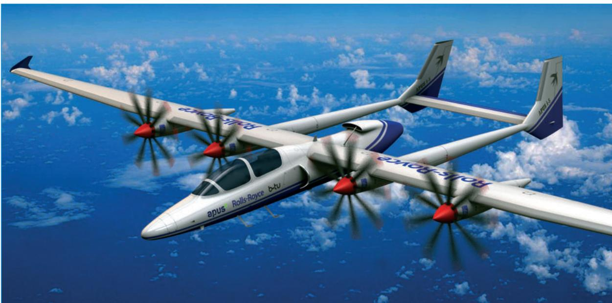
Hybrid-elektrisch: der APUS i-5 soll die Vorteile verteilter Antriebe demonstrieren ■
