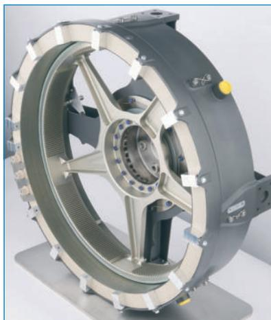
Der 200 kW starke Elektromotor, der den CityAirbus antreibt, hat ein für sein geringes Gewicht herausragendes Drehmoment ■
